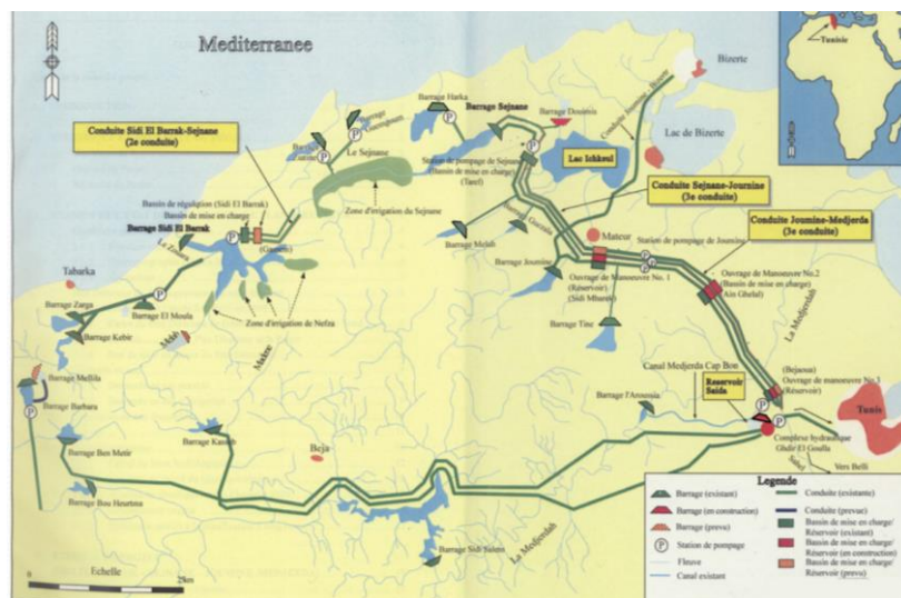
Figure 3 : réseau hydraulique interconnecté des barrages de l'extrême nord et du nord.
